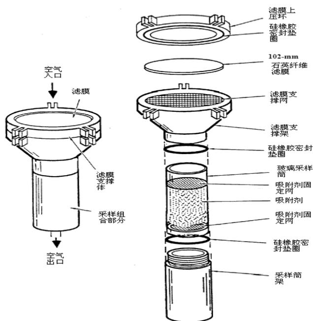
图 1 超大流量、大流量和中流量采样头结构示意图
