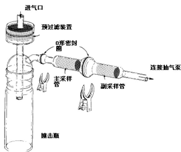
图 5 采集效率测定装置示意图
