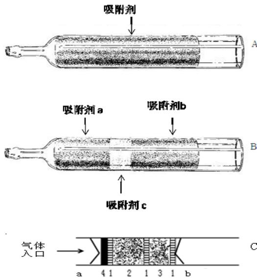
C 图 a—采样管的前端；b—采样管的后端；1—玻璃棉；2—前端吸附剂；
